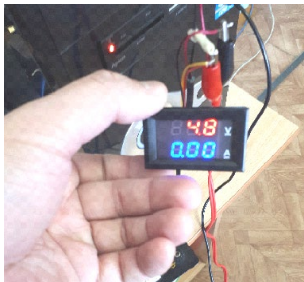
Рисунок 2 Напряжение на линии питания модуля NodeMcu v3
