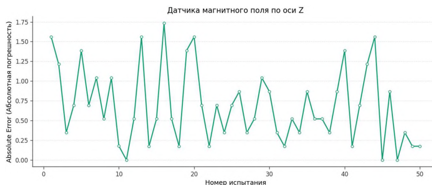
Сурет 5. Z осі бойынша магнитометрдің абсолюттік қателігін есептеу нәтижесі
