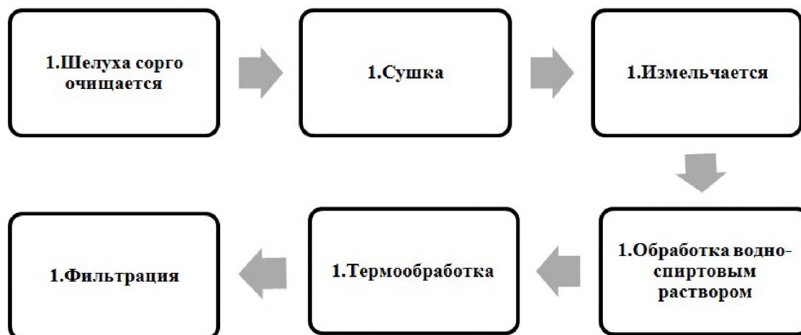
Рисунок 2. Схема получения натурального красителя из шелухи сорго
