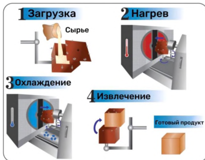
Рисунок 1. Иллюстрация процесса ротационного формования [26].
