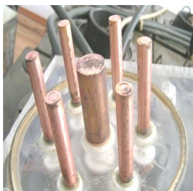
Рисунок 3 Электродная система ПФ и вакуумный разрядник установки КПУ–30
