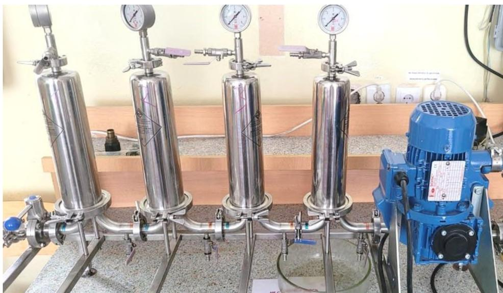
Рисунок 2. Корпусная установка для фильтрации модель MR63B4
