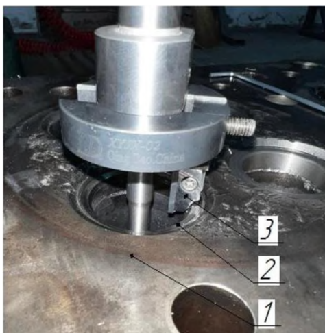
Рисунок 3. Фрезеровка седла клапана: 1 – головка блока; 2 – седло клапана; 3 – фреза многозубая
