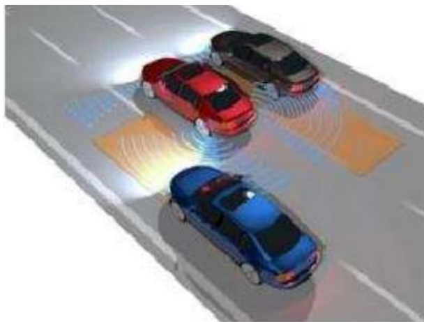
Рисунок 4. Синяя машина находится в слепой зоне водителя красной машины.
