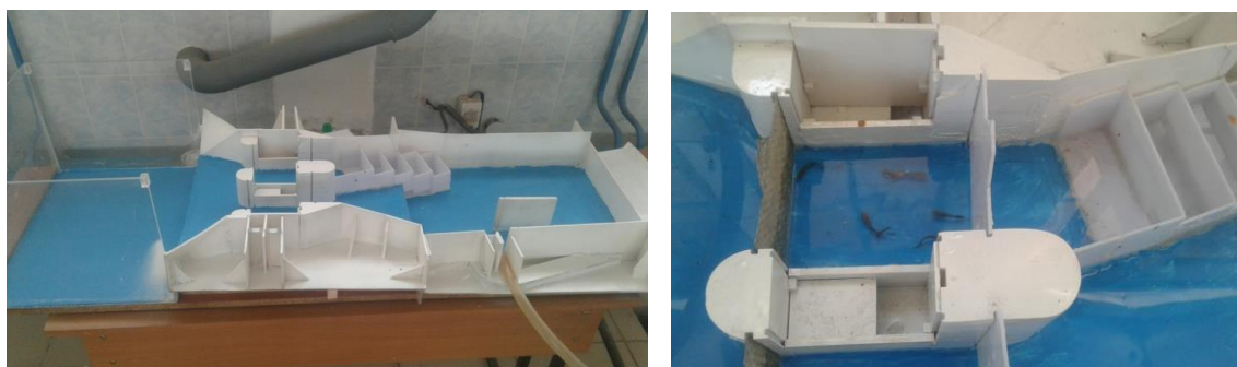
Сурет 2. Су өткізу құрылымының моделі
