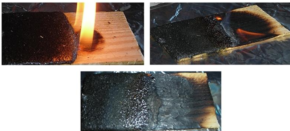
Сурет 8. Жалынның отқа төзімді жабыны бар үлгінің бетіне таралуы, оның бетінің бір бөлігіне ғана қолданылады.
