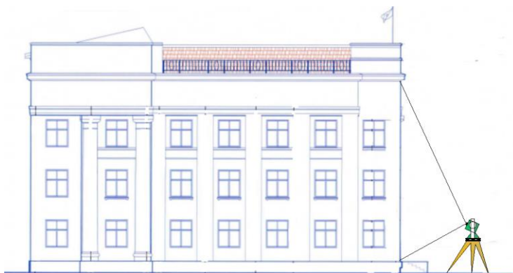
Сурет 2 Ғимарат бұрыштарының тік жазықтықтан ауытқуын координаталық әдіспен анықтау схемасы
