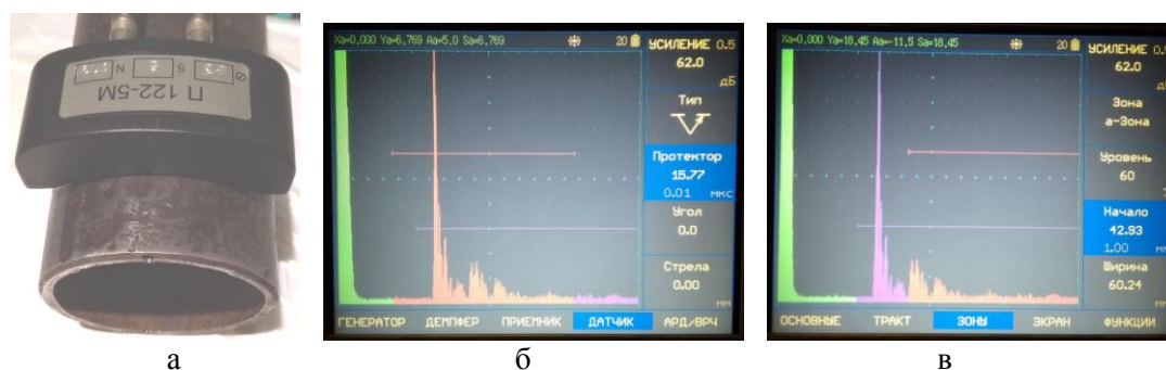
а - РС ПЭП расположен напротив конического дна отражателя ( \varnothing 2 мм, l=1 мм, s=12 мм) на расстоянии 19 мм от торца; б - Сигнал от конического дна отражателя ( \varnothing 2 мм, l=1 мм, s=12 мм); в - Сигнал от торца трубы.
