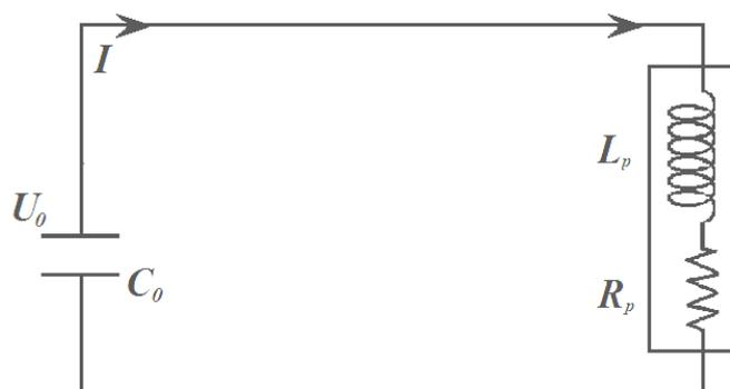
Рисунок 1 Эквивалентная схема установки ПФ без разрядника и токопроводящих проводов
