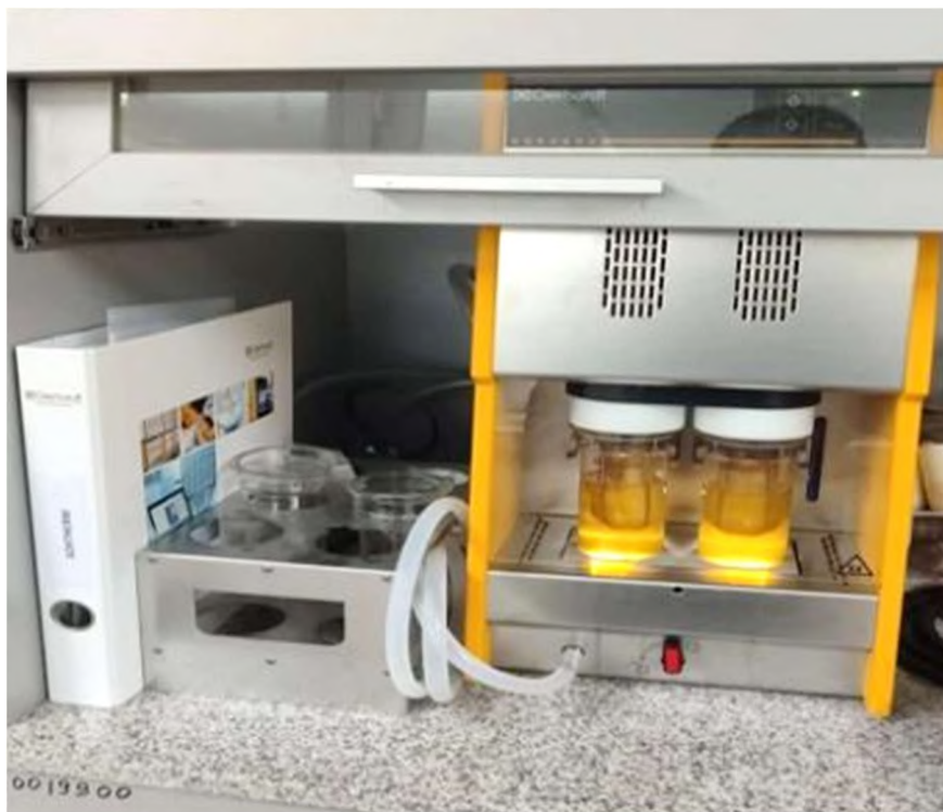
Рисунок 2. Получение экстрактов Chelidonium majus L. методом Сокслета (Gerhardt SOX-412).
