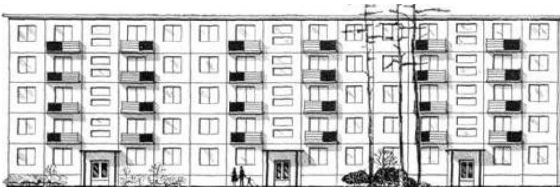
Рисунок 1 Фасад объемно-блочного 5-ти этажного жилого дома, СССР [8]
