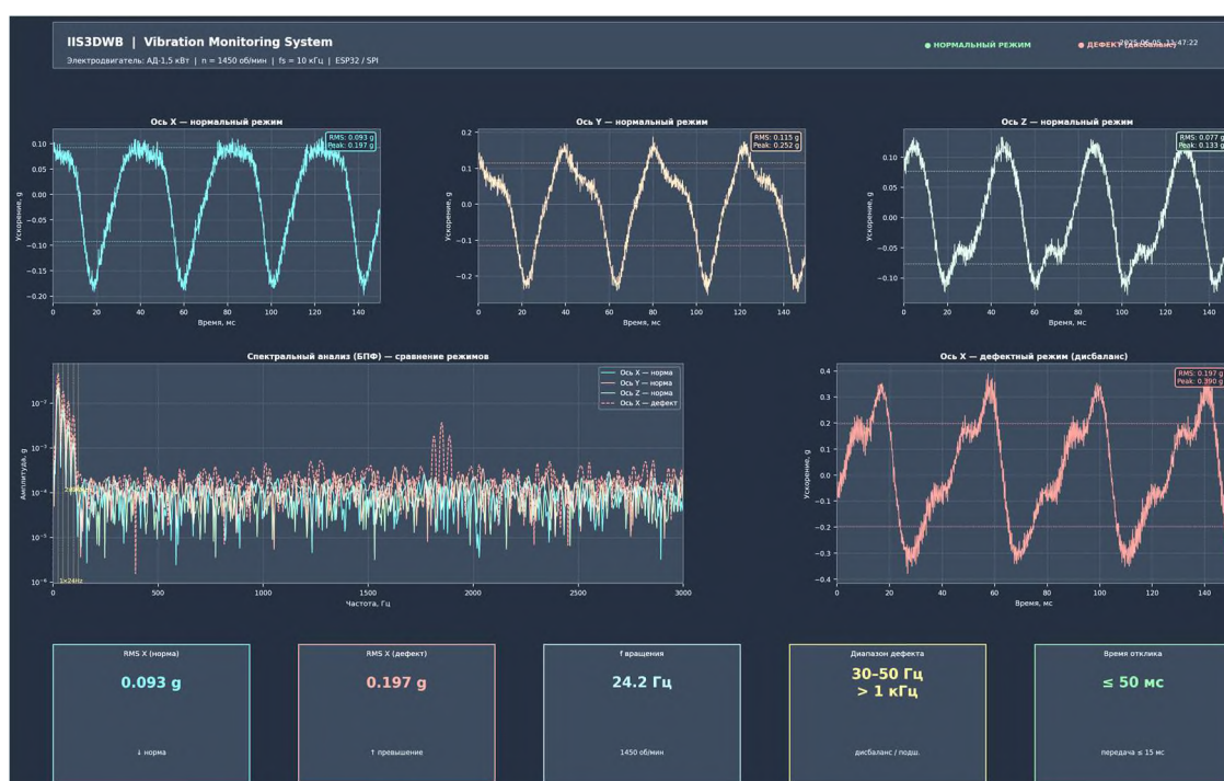
Рисунок 2. Дашборд системы вибрационного мониторинга: временные реализации вибрационных сигналов по осям X, Y, Z , спектральный анализ (БПФ) и сводные диагностические показатели
