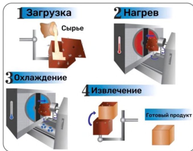
Рисунок 1. Иллюстрация процесса ротационного формования [26].
