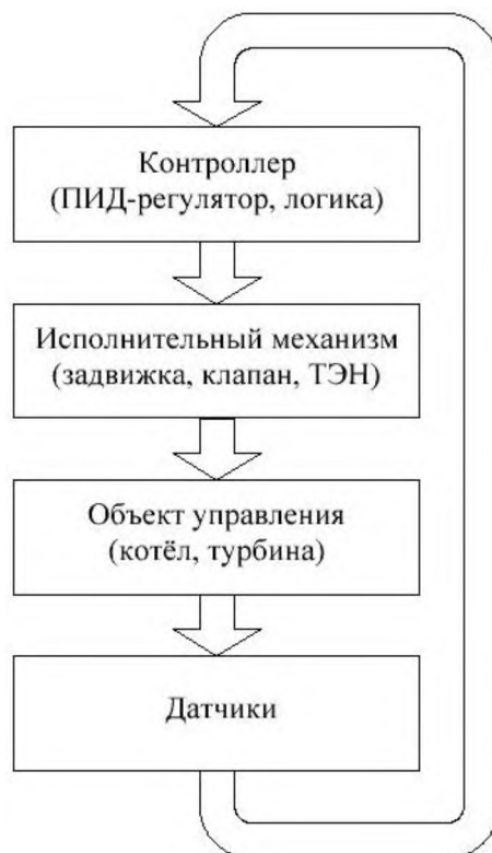
Рисунок 1. Блок-диаграмма типового контура регулирования
