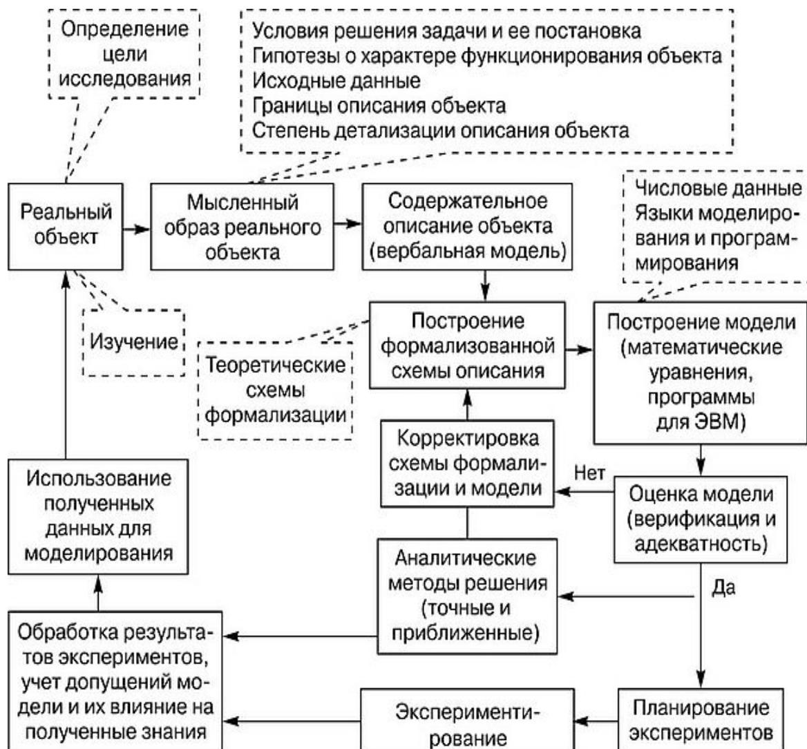
Рисунок 1 Процесс моделирования
