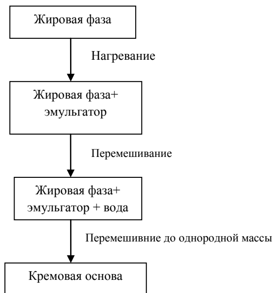
Рисунок 1 Технологическая схема создания косметических основ
