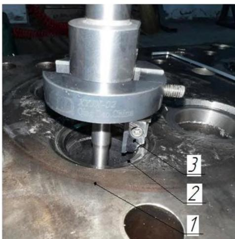
Рисунок 3. Фрезеровка седла клапана: 1 – головка блока; 2 – седло клапана; 3 – фреза многозубая
