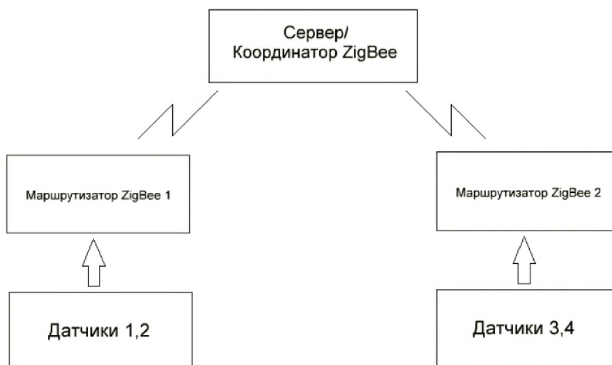
Рисунок 2. Структурная схема сети ZigBee для удаленного мониторинга состояния двух пациентов
