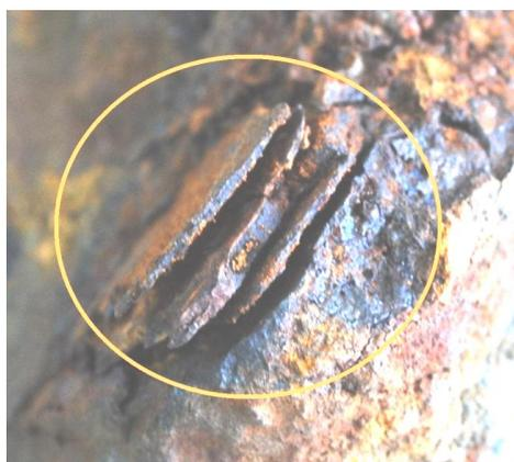
Рисунок 6 Пластинчатое (кристаллическое) расслоение окисленной металлической матрицы тела
